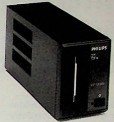
Afb. 7 VY0010, de nieuwe floppy disk drive, die Philips voor MSX-computers op de markt brengt.
